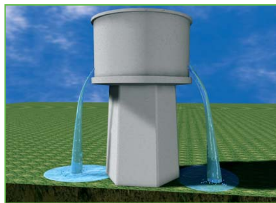
Wypełnione zbiorniki wodne nie są dostępne od wewnątrz, aby wykonać warstwę hydroizolacji. Żeby nie wyłączyć zbiornika z użytkowania, konieczne jest wykonanie hydroizolacji z zewnątrz (od strony negatywnej).
